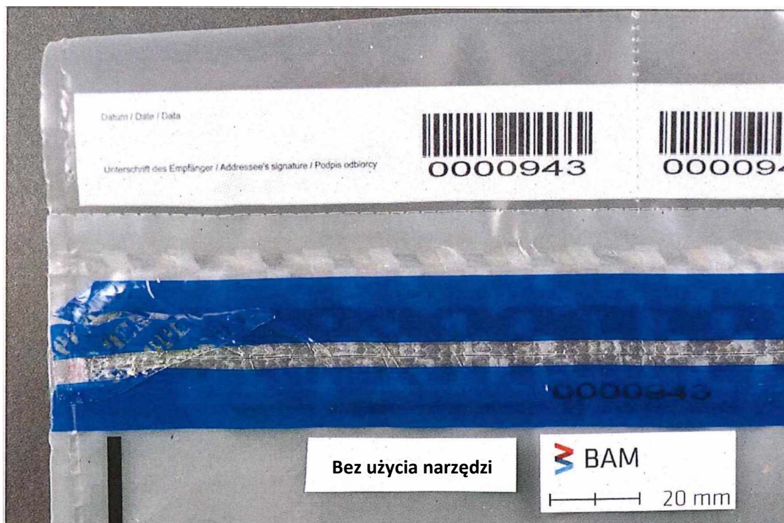
Rysunek 3 - Manipulacja bez użycia narzędzi, w temperaturze pokojowej
