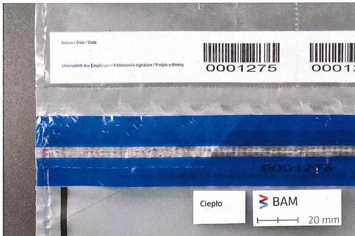
Rysunek 1 - Manipulacja z wykorzystaniem ciepła
