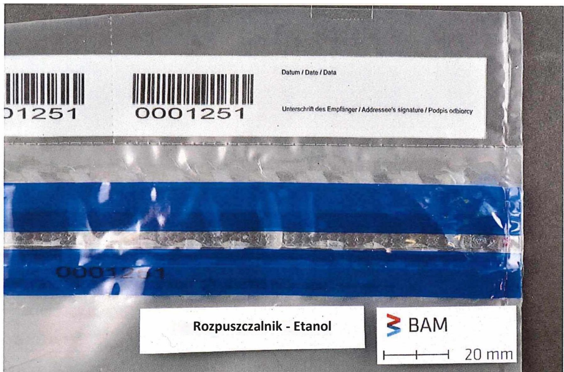
Rysunek 5 - Manipulacja rozpuszczalnikiem, etanolem
