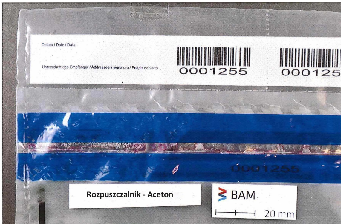
Rysunek 7 - Manipulacja rozpuszczalnikiem, acetonem
